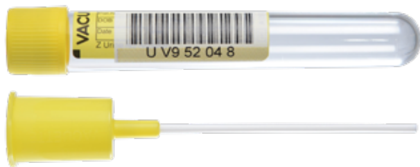
Urinanalyser. Vakuumrør med gul propp uten tilsetning. (10mL). Urinprøver merkes med etikett med sluttsiffer 8.
